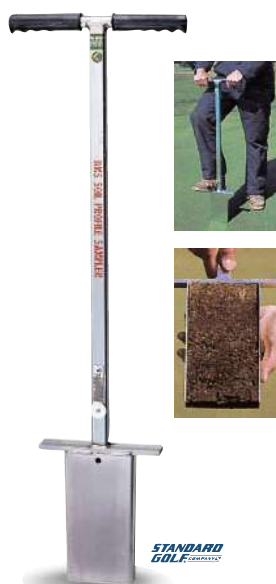
517-A ソイルテスター(大) 95×200×20t mm スチール製 深さ20cm、幅10cm、厚さ2cmの土壌 サンプルを抽出できます。面でサン プルを採取するため、細かく芝生 の根の確認を行うことができます。
