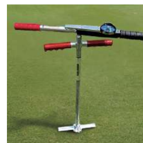
538 シェアストリングステスター 850mm 先端部 ステンレス製 本体 亜鉛メッキ製 ハードケース付き 重量3.4kg 芝の水平方向のせん断力を計測す る器具です。先端部を芝に差し込み、 芝が裂け始めるまでハンドルを回す とせん断力が計測できます。
