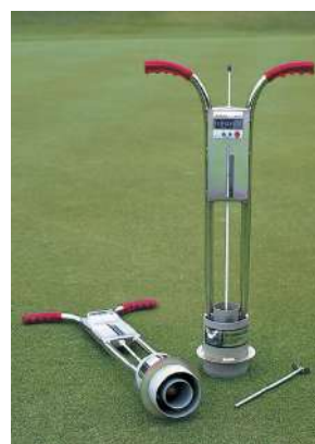
1000 インフィルトロメーター (水浸透速度計) 150Φ×830mm スチール製 ターフエリア専用の水の浸透速度を 現場で測定することができます。浸 透速度データーを散水管理に生かす こともでき、エアレーション、パーチ カット、トップドレッシング等の作業効 果を数字で把握することができます。 浸透速度が「2.5cm/h以下」のグリー ンは危険の境界線上にあると理解す べきです。
