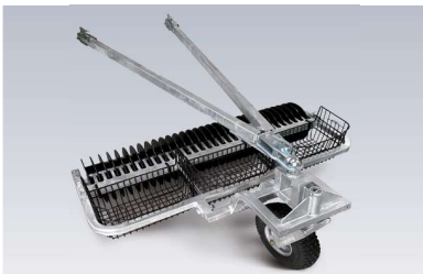
725-H 取付型ボールギャザー1000 幅1500mm フレーム: スチール製 ドラム: 樹脂製 重さ: 83kg 1000球収容可能 カートに取り付けるタイプの新しいボールギャザーが登場しました。カートを使用することにより大量のボールピッキング作業ができます。ギャザー自体がスムーズにコーナーを曲がり、作業時間を節約でき、作業性が向上します。
