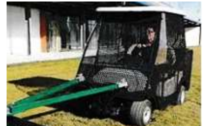
725-H-2 カート用防護ネット 金属製バンチング加工による防護ネット スチール製 ゴルフカートの種類によりお見積りさせていただきます。カートに防護ネットを取り付けることで作業者を飛球から守り、営業時間内での集球作業が可能になります。時間帯を気にせずに作業できるので作業効率が大幅に上がります。
