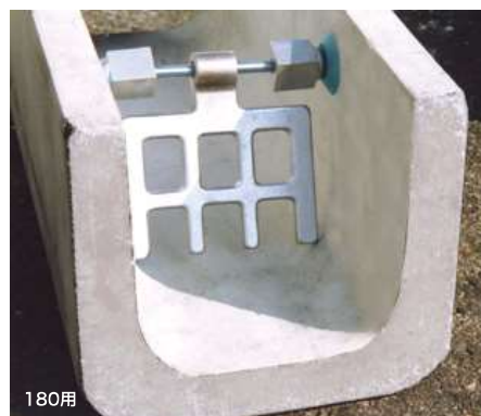
533 ボールストッパーアルミ 140×140mm アルミ製 U字溝180用 534 ボールストッパーアルミ 195×195mm アルミ製 U字溝240用 535 ボールストッパーアルミ 240×205mm アルミ製 U字溝300用 <ボールストッパーの設置方法> 両端の袋ナットを戻し廻してコノエダブルをU字溝の側面に押し付けて下さい。工具は不要です。
