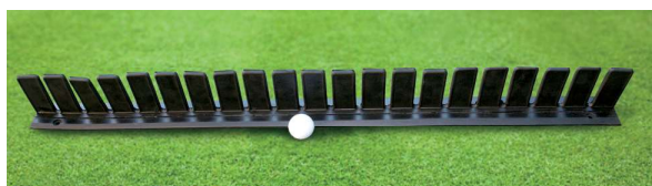
536-A KMSボールストッパーMK2 1000×110H×80tmm ゴム製 高品質なゴムを使用し耐久性に優れています。止板が櫛状になっており、ゴルフカートや管理車両等の乗り越え時に衝撃が少ない構造です。
