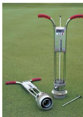
1000 インフィルトロメーター (水浸透速度計) 150Φ×830mm スチール製 ターフエリア専用の水の浸透速度を 現場で測定することができます。浸透 速度ゲージを散水管理に生かすこ ともでき、エアレーション、パーチカ ット、トップドレッシング等の作業効果 を数字で把握することができます。浸透 速度が「2.5cm/h以下」のグリーンは 危険の境界線にあると理解すべき です。
