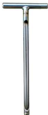
517-C ソイルテスターミニ 19Φ×205×525mm 474g スチール製 持ち運びに便利なサイズのソイルテ スターです。深さ375mm・幅(径)約19 Φmmの土壤サンプルを抽出できます。 土壤分析にお役立てください。
