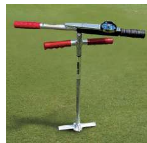
538 シェアストリングステスター 850mm 先端部 ステンレス製 本体 亜鉛メッキ製 ハードケース付き 重量3.4kg 芝の水平方向のせん断力を計測する 器具です。先端部を芝に差し込み、芝 が裂け始めるまでハンドルを回すと せん断力が計測できます。
