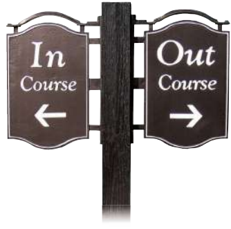
489-B OUT-IN指示板 600×400×20tmm アルミ製 両面表示 2枚 130×130×2000mm 擬木製足 スチール芯入り フェンス用基礎を使用ください。 ※クラブマーク付等別注表示品についてはシート加工にて対応いたします。
