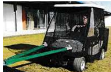
725-H-2 カート用防護ネット 金属製/パンチング加工による防護ネット スチール製 ゴルフカートの種類によりお見積りさせていただきます。カートに防護ネットを取り付けることで作業者を飛球から守り、営業時間内での集球作業が可能になります。時間帯を気にせず作業できるので作業効率が大幅に上がります。
