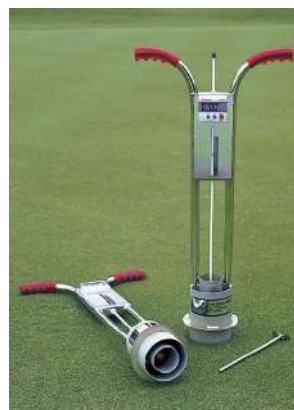
1000 インフィルトロメーター (水浸透速度計) 150Φ×830mm スチール製 ターフエリア専用の水の浸透速度を 現場で測定することができます。浸透 速度データーを散水管理に生かすこ ともでき、エアレーション、バーチカッ ト、トップドレッシング等の作業効果を 数字で把握することができます。浸透 速度が「2.5cm/h以下」のグリーンは 危険の境界線上にあると理解すべき です。
