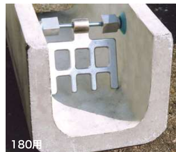
533 ボールストッパーアルミ 140×140mm アルミ製 U字溝180用 534 ボールストッパーアルミ 195×195mm アルミ製 U字溝240用 535 ボールストッパーアルミ 240×205mm アルミ製 U字溝300用 ＜ボールストッパーの設置方法＞ 両端の袋ナットを戻し廻しにてコノエダブルをU字溝の側面に押し付けて下さい。 工具は不要です。
