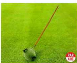
724 ローリングボールピッカー 215φ×350mm ステンレス製 柄:1270mm 木製 ヘッド部が60本の金属製スポークを転がすことで簡単にボール回収することができます。ボールは備え付けのスポーク巾を広げる金具で簡単に取り出せます。芝生にも優しいボール回収機です。
