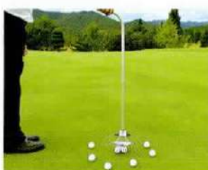
723 練習場用ボールピッカー 最長寸法:1000mm アルミ+ステンレス製 長さ調節可能 ゴルフボールを拾う用具で、ボールの上から軽く押すだけでステンレス製の弾力によってボールが輪の中に飛び込みます。
