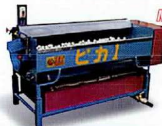
506T-GP 洗球機 大型 660×1950×640Hmm 重量190kg 電源200V 750W 使用した洗剤入り洗浄水を再循環させて洗いますので洗浄水の使用量に限りがある場所にも適しております。1回に2500個のボールを洗うことができます。 ※洗剤使用可能です。
