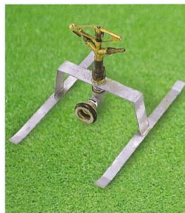
991・992 スプリンクラー グリーン用 ソリ台・マチノ金具付 ノズル口径7.5×5.5 圧力3.0kg/cm 2 水量66.6ℓ/min 撒水径34m
