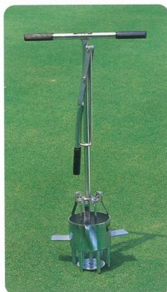
771 ハンディーエアレーター 部分的にエアレーションを必要とする場合に7本の1/2インチタインが便利です。タインが7本、足で打ち込むとコアは中央の容器に回収されます。きれいにタインを引き抜くことができます。ターフの補修作業に便利な道具です。
