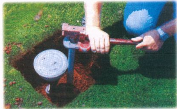
542 バーチカル・パイプ・レンチ スプリンクラーヘッド取換、点検に！ 地上部で操作できるのが特長で、掘削穴の大きさは従来の1/4ですみます。 最大サイズ:2インチまで
