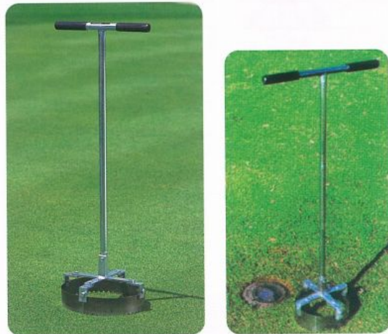
504-S スプリンクラーヘッドカッター 152φ~265φまでサークルを10段階に変更でき、2枚の鋸刃状ブレードが付きます。(散水後の作業が簡単です。)
